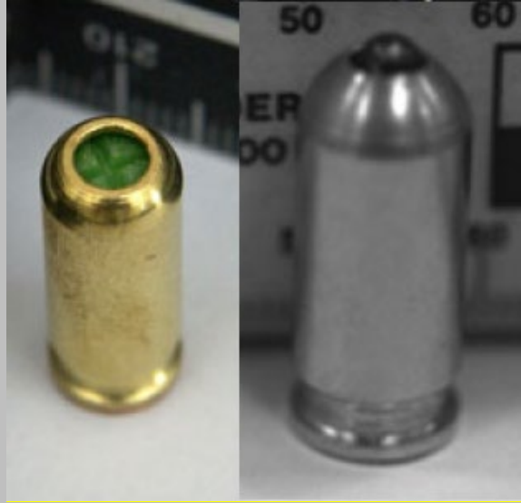
Solda: Değiştirilmemiş boş bir mermi; Sağda: Metal kürenin eklenmesiyle dönüştürülen boş bir mermi. 106
