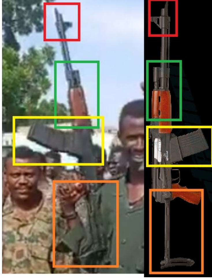
FD-63 varyantıyla karşılaştırıldığında videonun düzenlenmiş ekran görüntüsü (ayrıt edici özellikleri vurgulanmıştır). 68 Soldaki av tüfeği daha büyük bir şarjörle donatılmıştır.
